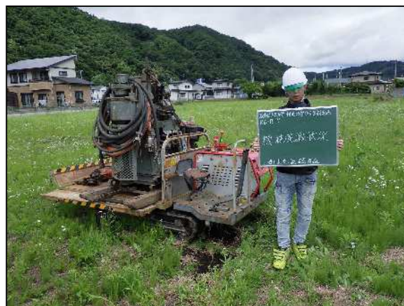
図-2.1.2 資機材運搬用特装運搬車概略図および運搬状況の例
